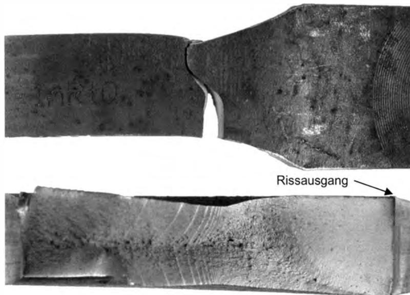
Bild 83 Exemplarisches Bruchbild (oben) mit Bruchfläche (unten) des Prüfkörper 355-15-Na-1
