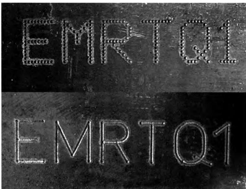
Bild 15 Vergleichende Darstellung unterschiedlicher Nadelmarkiermethoden
