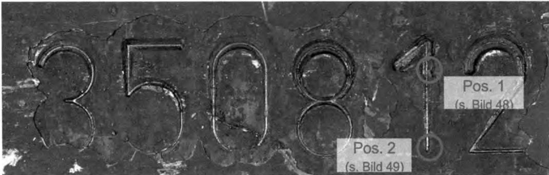
Bild 47 Übersicht der Stellen der Mikroskopbilder des Prüfkörpers S460-15-St-7
