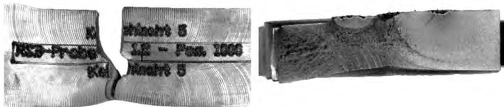
Bild 38 Bruchbilder (links) und Bruchfläche (rechts) des Versuchsbauteils P-04-10A
