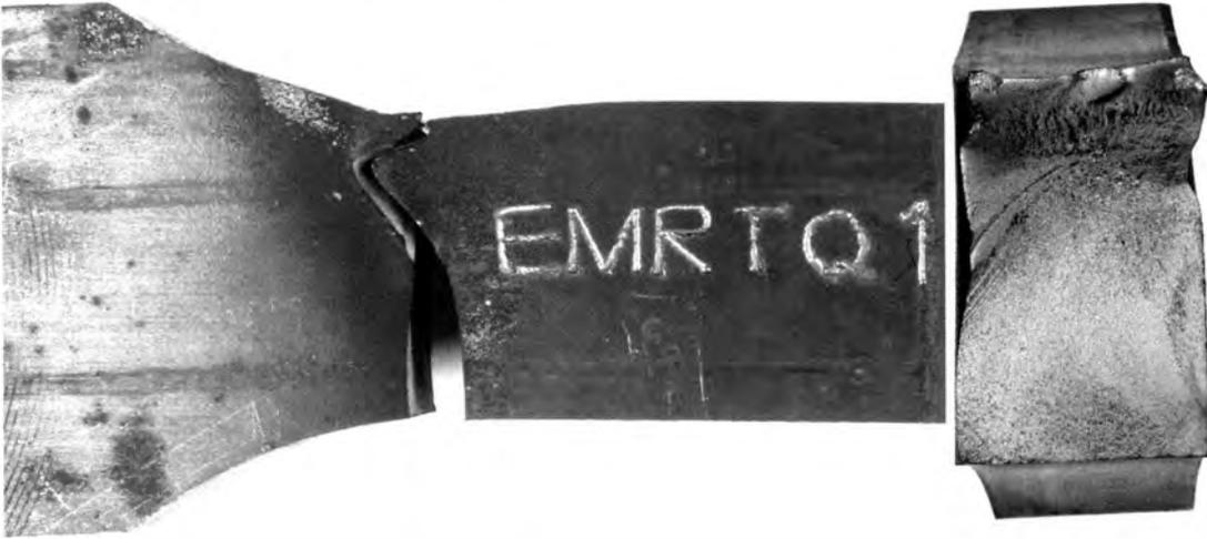
Bild 81 Exemplarische Bruchbilder des plasmamarkierten Prüfkörpers 460-40-PI-06 mit Rissausgang im Grundmaterial
