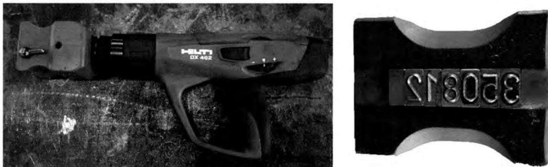
Bild 6 Beispiel einer mobilen Kennzeichnungsmaschine für hartes Stempeln der Firma HILTI
