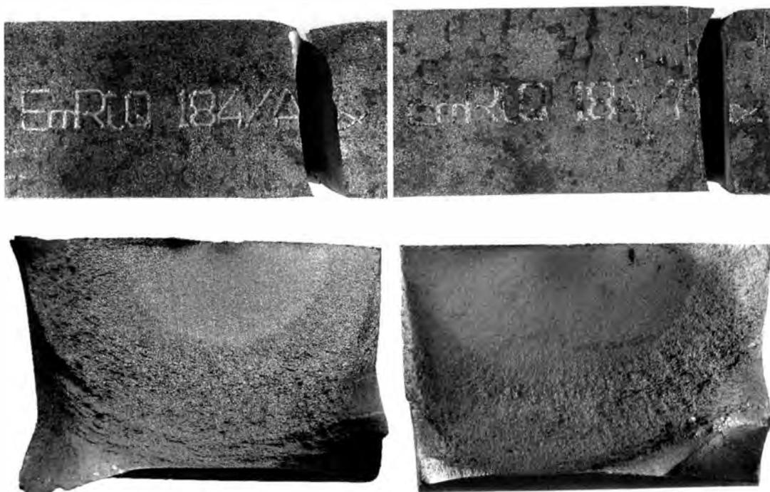
Bild 75 Exemplarische Bruchbilder der gefrästen Prüfkörper 355-40-Fr-01 mit  $\Delta\sigma = 317,5 \text{ N/mm}^2$  (links) und 355-40-Fr-04 mit  $\Delta\sigma = 261,5 \text{ N/mm}^2$  (rechts)
