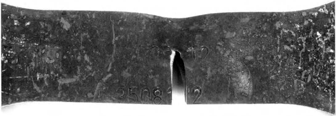
Bild 72 Exemplarisches Bruchbild des Prüfkörpers 460-25-St-06 mit doppelter Markierung
