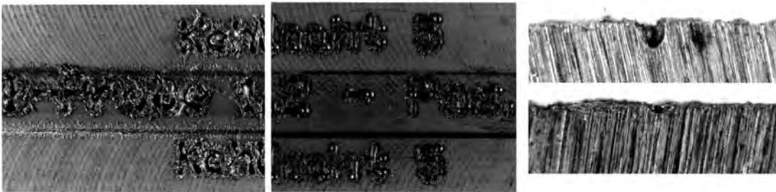
Bild 34 Plasmamarkierte Prüfkörper (links) und Darstellung von Makroschliffen (rechts) mit Angabe der Kennzeichnungstiefe
