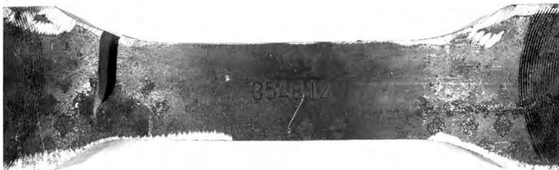
Bild 69 Rissausgang des Prüfkörpers 355-40-St-05 im Grundmaterial (Übergang zwischen tailliertem und eingespanntem Bereich)
