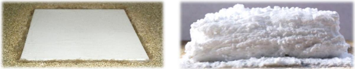
Abbildung 2-10: Mit einem reaktiven Brandschutzsystem beschichtete Stahlplatte vor (links) und nach (rechts) einer thermischen Einwirkung
