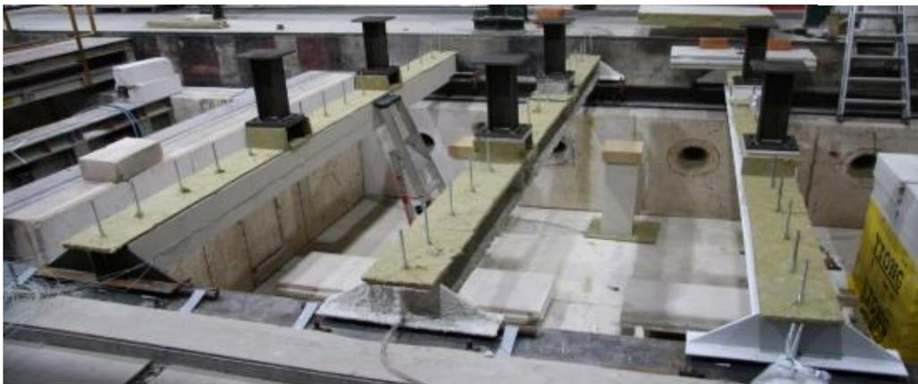
Abbildung 5-2: Position der Thermoelemente über die Versuchskörperlänge der belasteten und geschützten Stahlträger
