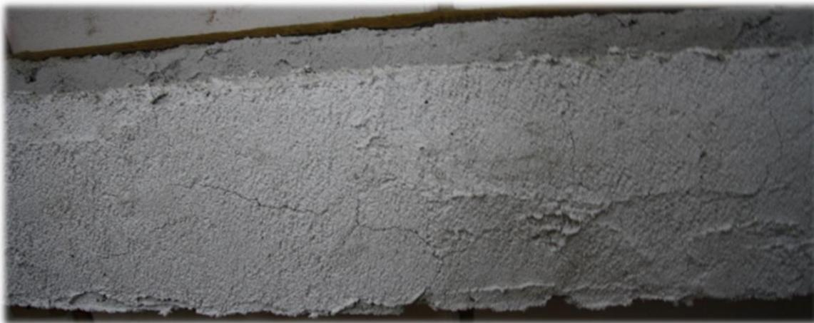
*Abbildung 5-34: Unterseite des belasteten Stahlträgers mit 15 mm Brandschutzputz nach der Naturbrandbeanspruchung*
