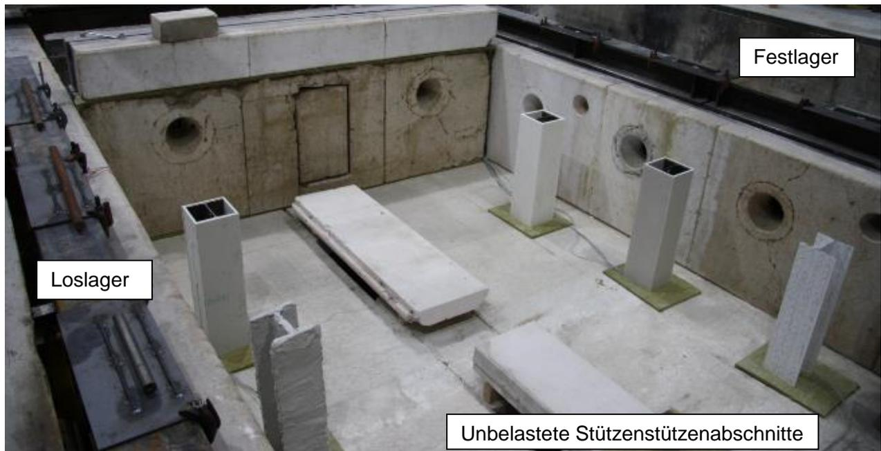
Abbildung 5-12: Position der unbelasteten Stützenstummel im Brandraum
