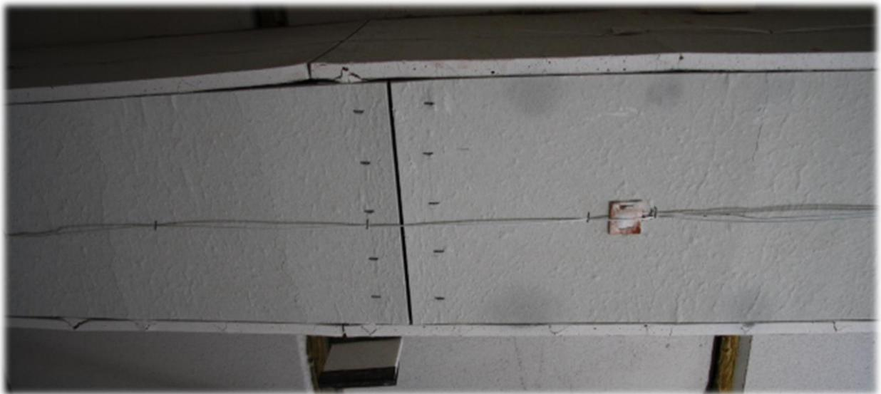
*Abbildung 5-25: Unterseite des belasteten Stahlträgers (HEA 249) mit einer Lage 15 mm dicken Gipskartonfeuerschutzplatte*
