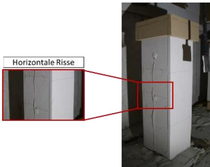
*Abbildung 5-22: Unbelasteter Stahlstützenabschnitt mit Calciumsilikatplatte 20 mm, einlagig; nach der Naturbrandbeanspruchung*
