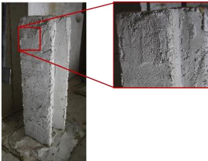
*Abbildung 5-31: Unbelasteter Stützenstummel mit Brandschutzputz 15 mm, profilfolgend; nach der Naturbrandbeanspruchung*
