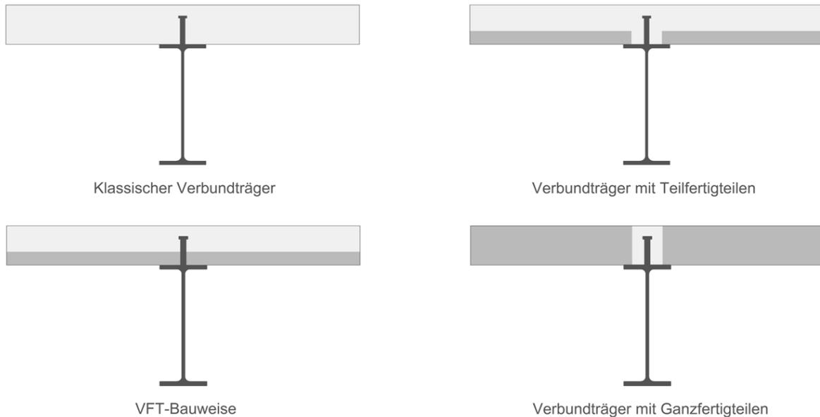
**Abb. 1-1:** Fertigteile in Verbundträgern [11]
