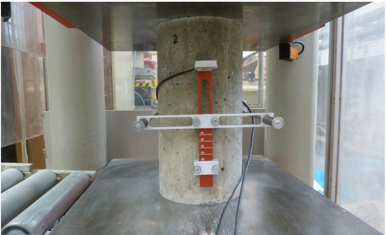
**Abb. A-10:** Laborprüfung E-Modul
