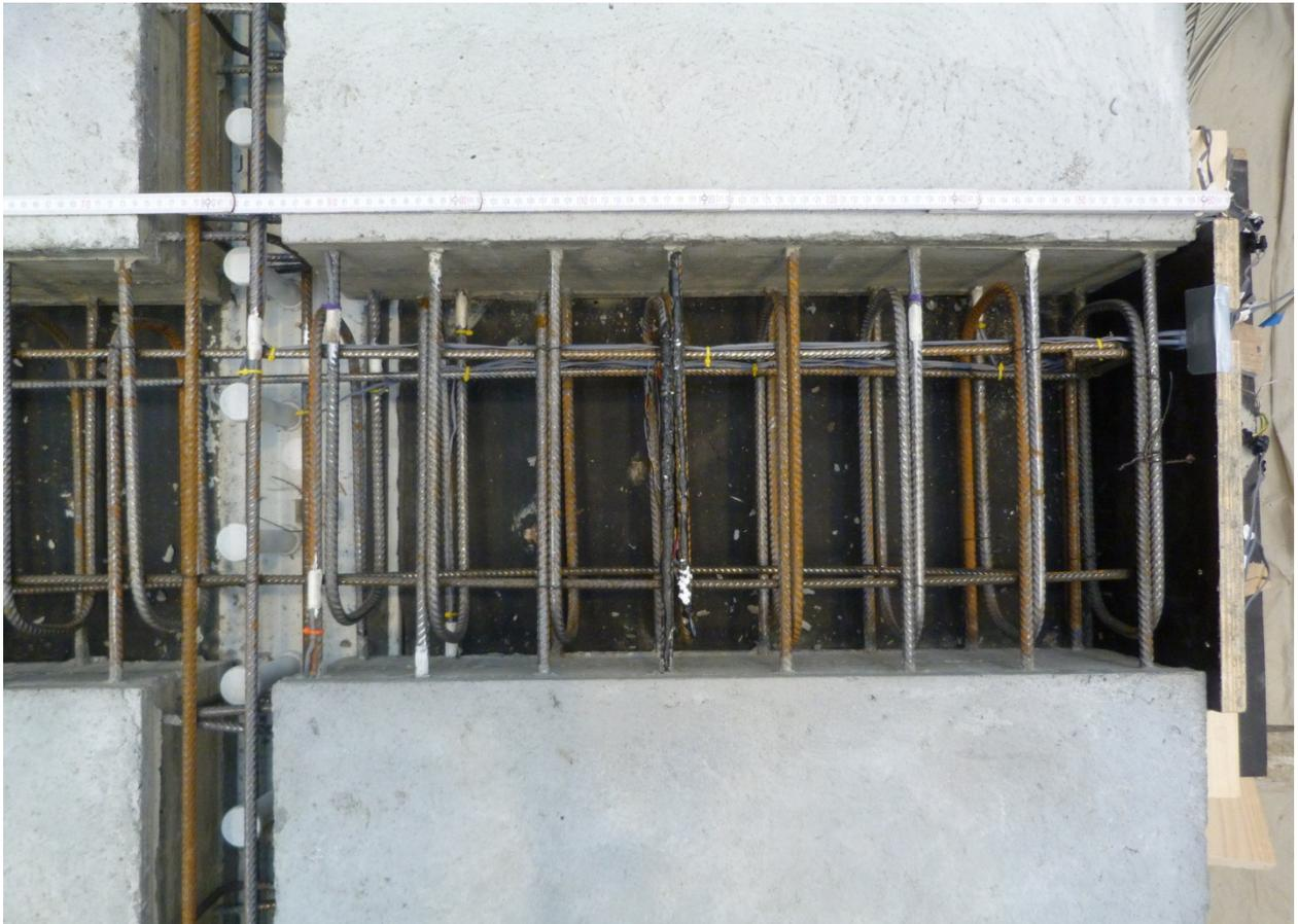
**Abb. A-9:** Fugenbereich GFT-Träger mit Messtechnik
