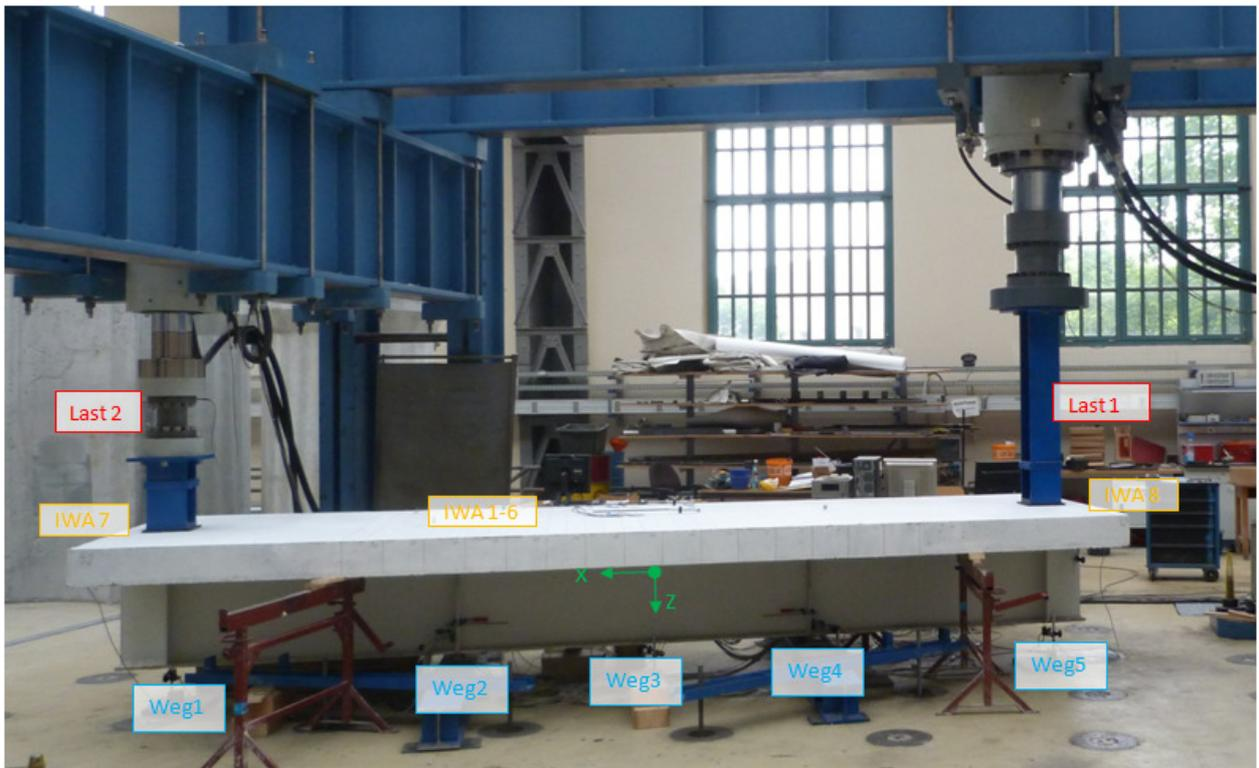
Abb. A-12: Versuchsträger und Prüfeinrichtung mit Übersicht Messtellen
