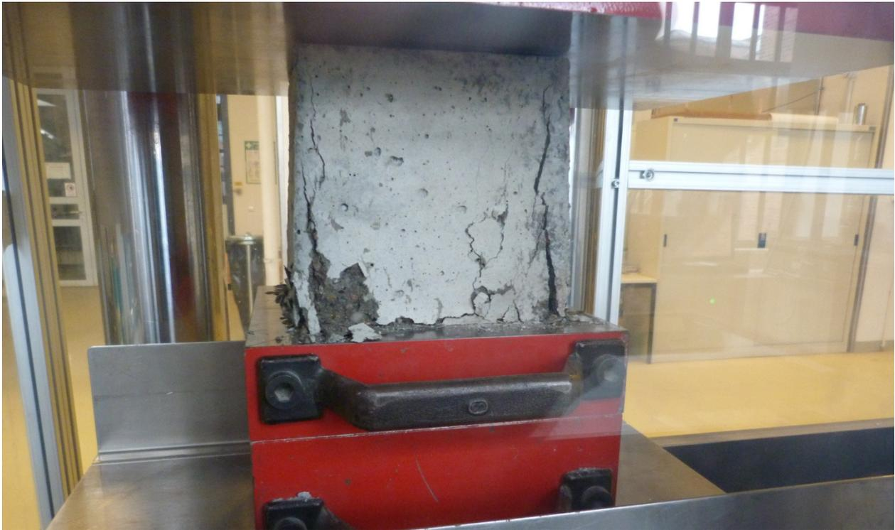
Abb. A-11: Laborprüfung Druckfestigkeit
