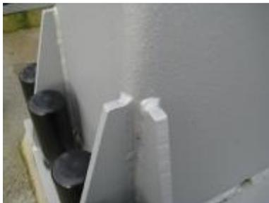
Anschluss Steife an ein kaltgefertigtes Hohlprofil
