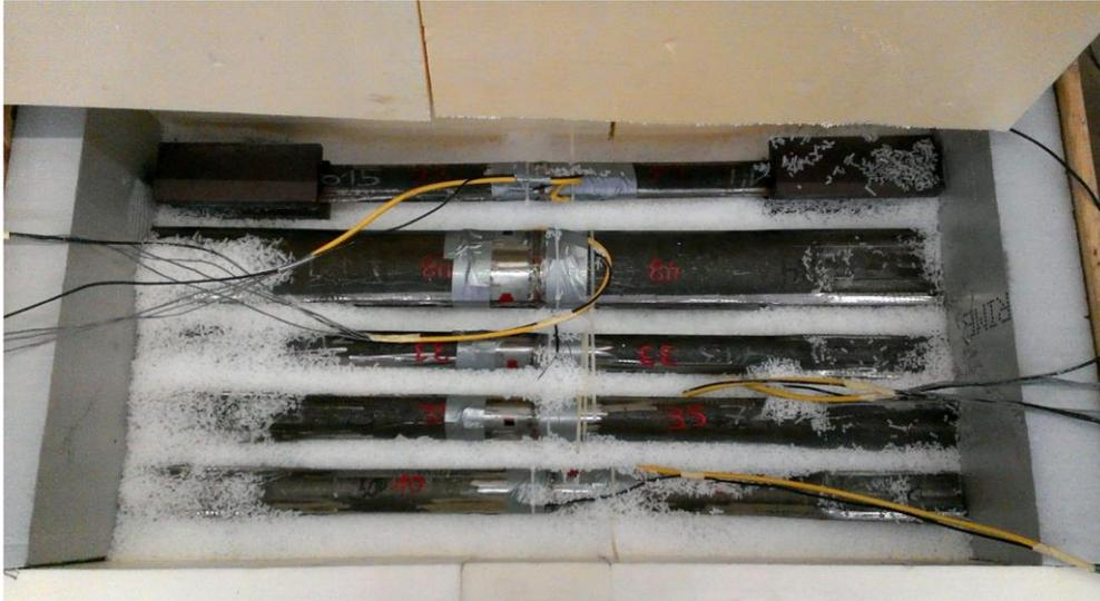
Abbildung 7.13: In Trockeneis eingelegte Prüfkörper mit applizierter Messtechnik
