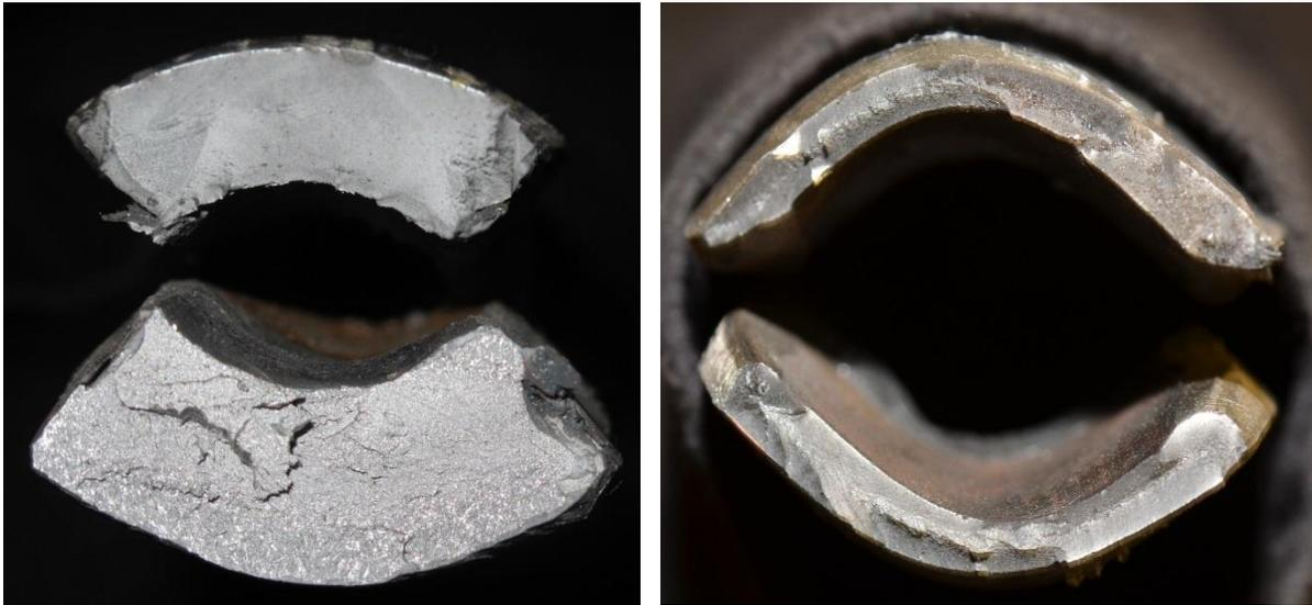
a) Prüfkörper 42: Sprödes Versagen, beide Halbschalen zeigen eine glatte Bruchfläche
