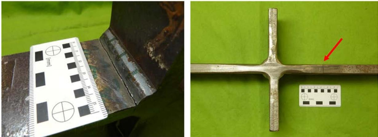
Abbildung 3-15: Quersteife mit Ermüdungsrisss am Nahtübergang (Zustand aw, links) und HFH-behandelte Quersteife mit Grundmaterialbruch (rechts)
