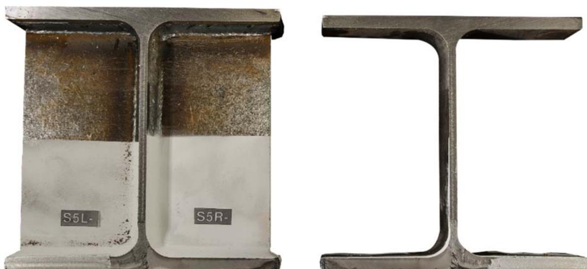
Abbildung 3-29: Bruchbild Versuchsträger T1 AW [3]
