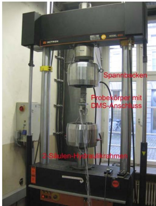
Abbildung 6-7: DMS-Messung an Quersteife am KIT
