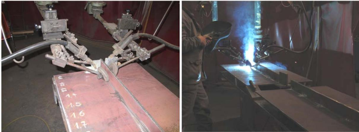
Abbildung 3-9: Paralleles Schweißen der Kehlnähte beidseits der Steife mit WeldyCar
