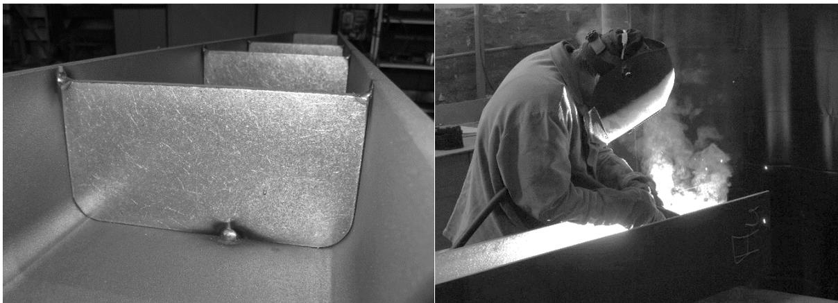
Abbildung 3-20: Anheften und Einschweißen der Quersteifen in Wannenlage [3]
