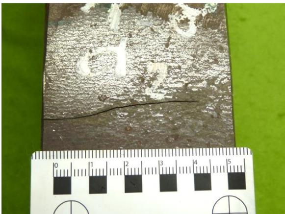
Abbildung 3-43: HFH-behandelte Quersteife mit Ermüdungsriss im Grundmaterial,  $R = -1$
