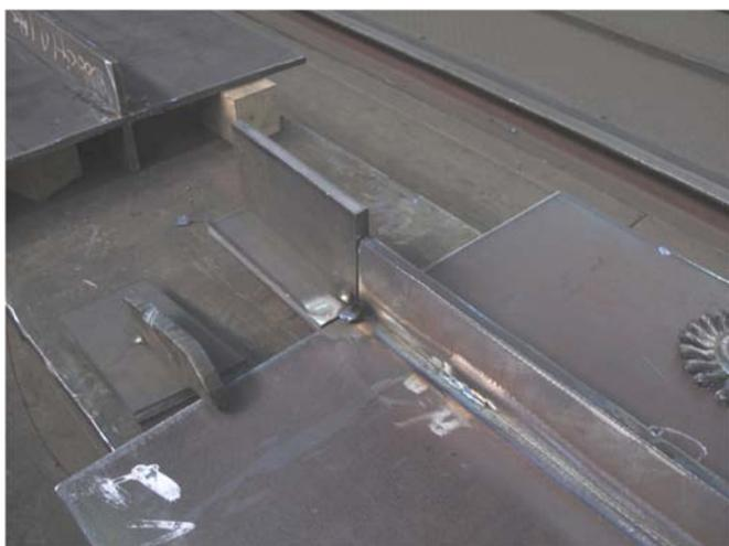
Abbildung 3-8: Anheften der Steifen und Anbringen von An- und Auslaufblechen
