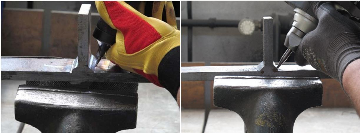
Abbildung 3-12: Kleinprüfkörper: HiFIT-behandlung (links) und PIT-Behandlung (rechts)
