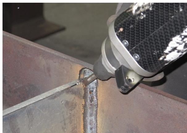
Abbildung 3-22: Nachbehandlung mit PIT durch die Firma *Pitec GmbH* [3]
