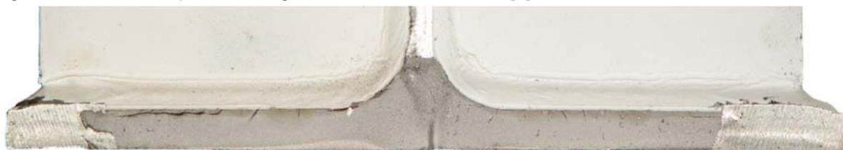
Abbildung 3-32: : Bruchbild Versuchsträger 2.18 – Steife Nr. 5 – Detailansicht [3]
