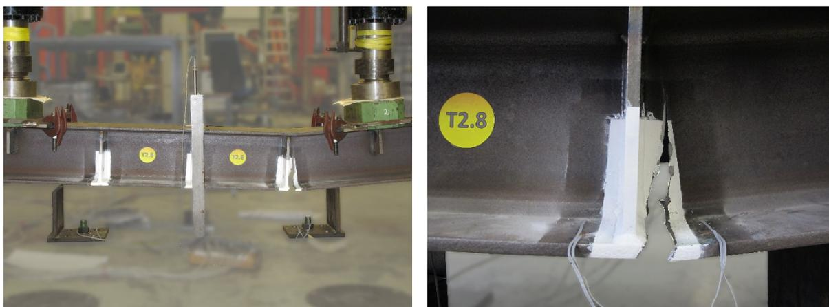
Abbildung 3-27: Versagen der Trägerserie T2 am Nahtübergang der Quersteife [3]
