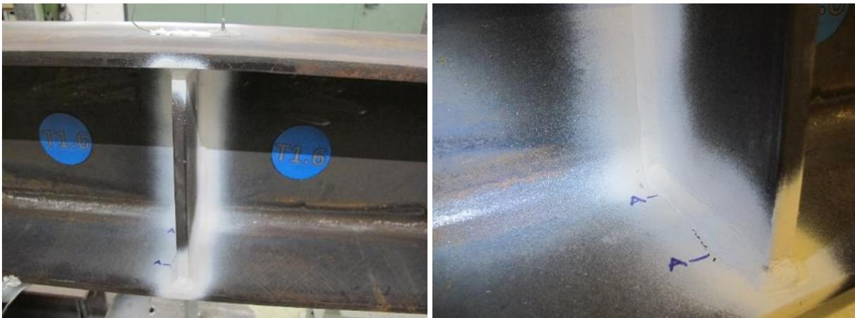
Abbildung 3-57: Typische Rissbildung an Untergurtschweißnaht [3]
