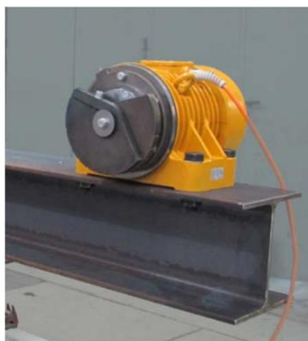
Abbildung 3-51: Schalungsrüttler der Firma *Knauer Engineering Industrieanlagen GmbH & Co.KG* [3]
