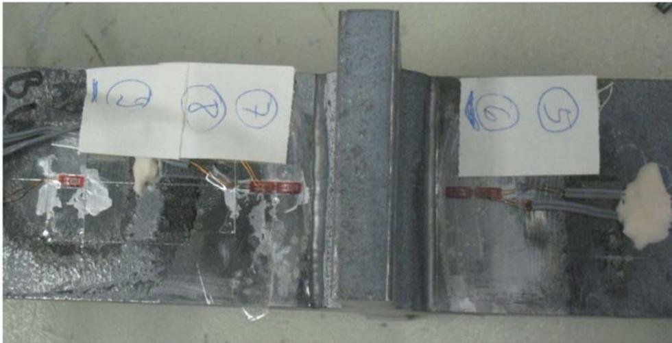
Abbildung 6-6: Applikation der DMS auf Quersteife
