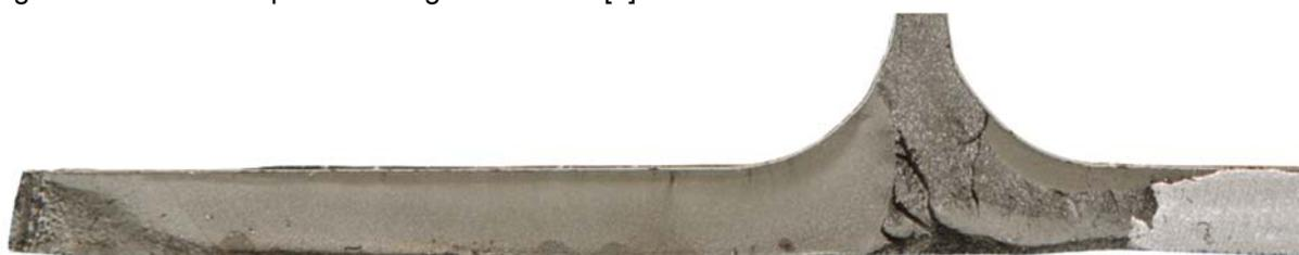
Abbildung 3-30: Bruchbild Versuchsträger T1 AW – Detailansicht [3]
