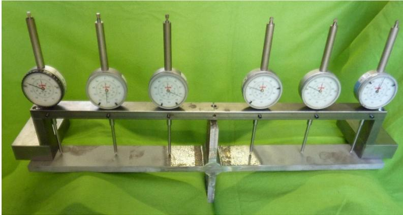
Abbildung 6-3: Messvorrichtung zur Messung des Verzugs
