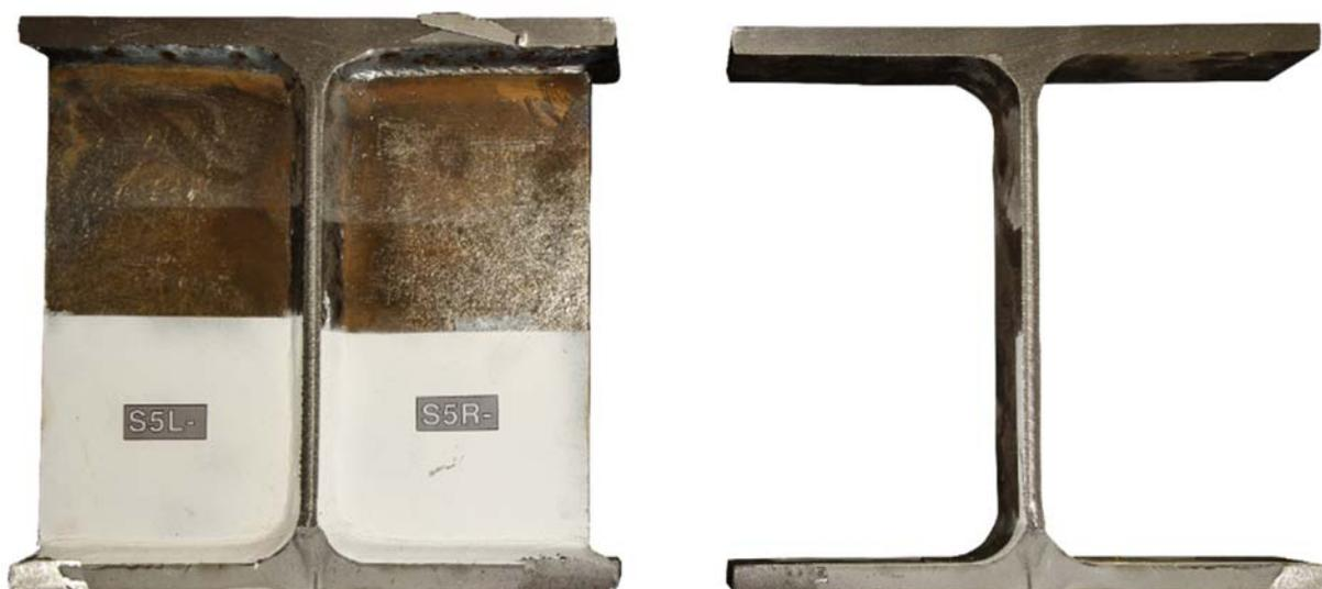
Abbildung 3-31: : Bruchbild Versuchsträger 2.18 – Steife Nr. 5 [3]
