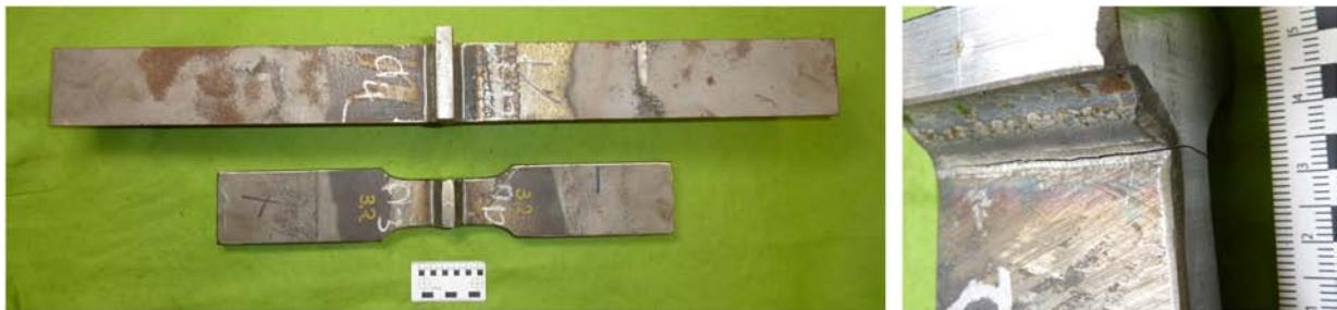
Abbildung 3-45: Quersteife tailliert und nicht tailliert (links), Ermüdungsriss am HFH-behandelten Nahtübergang eines taillierten Prüfkörpers (rechts)
