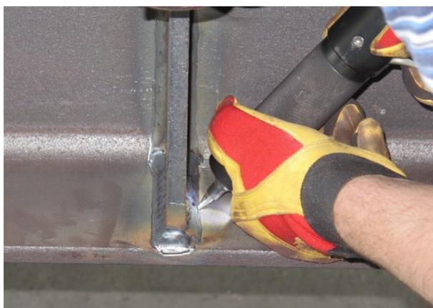
Abbildung 3-21: Nachbehandlung mit HiFIT durch die Firma *DYNATEC GmbH* [3]
