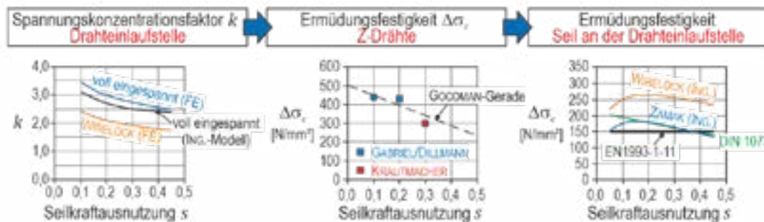
Abbildung 3: Seilermüdungsfestigkeit aus Spannungskonzentr. und Drahtermüdung
