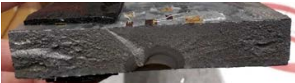
Abbildung 2: Bruchoberfläche des Probekörpers des zweiten Tastversuches
