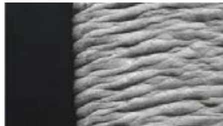
Abbildung 1: Oberflächenstruktur eines WAAM-Blech
