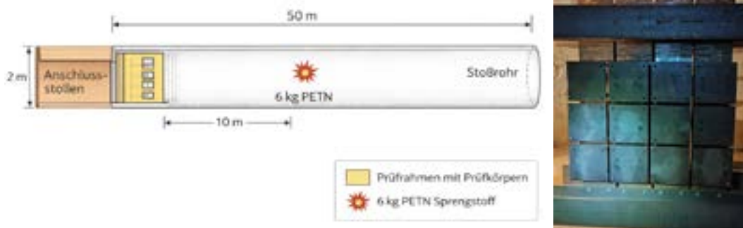
Abb. 1a (links): Versuchsaufbau Sprengtunnel WTD52, Abb. 1b (rechts) Foto Prüfkörper und Prüfrahm am Sprengtunnelmund mit Blick auf Druckplatten
