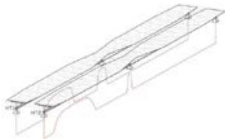
Abbildung 2: Ausbildung der Fließzonen bei Erreichen von \epsilon_u
