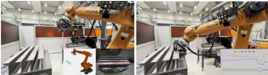
Abbildung 3: Prozessschritte des Pick-up-Skills: links: grobe Positionierung und Identifizierung einer potenziell gültigen Greifposition durch eine Stereo-Tiefenkamera, rechts: präzise taktile Anpassung für einen sicheren Kontakt mit dem Bauteil
