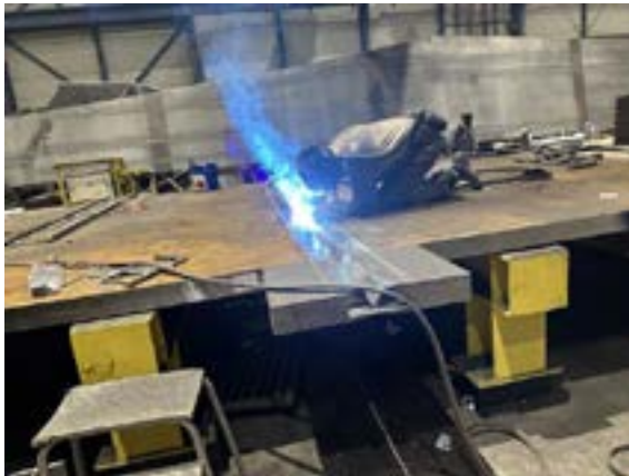
Abbildung 2 links: Schweißen der ersten Lagen eines Stumpfstoßes einer Dickblechbrücke; rechts: Makroschliff einer Stumpfnaht an einem S275NL t = 100 mm
