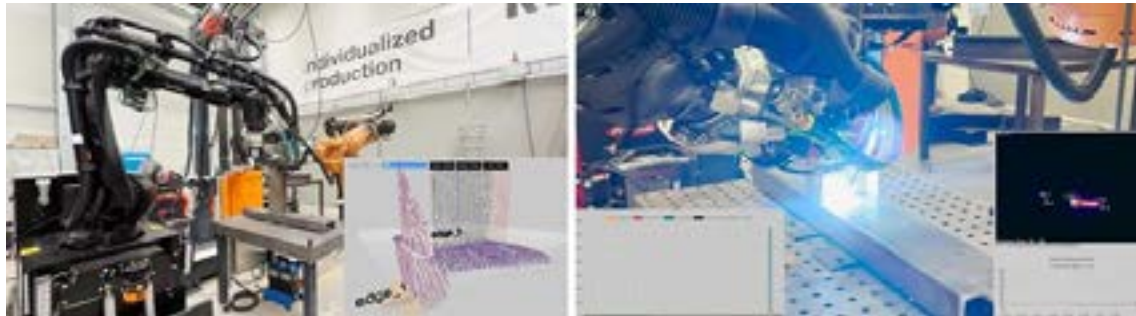
Abbildung 4: Prozessschritte des Scannens und Schweißens, links: Ergebnis des extrahierten Schweißpfads im virtuellen Dienst „Point-Cloud-Interpreter“, rechts: Live-Sensorüberwachung der Schweißparameter und das Wärmebild.
