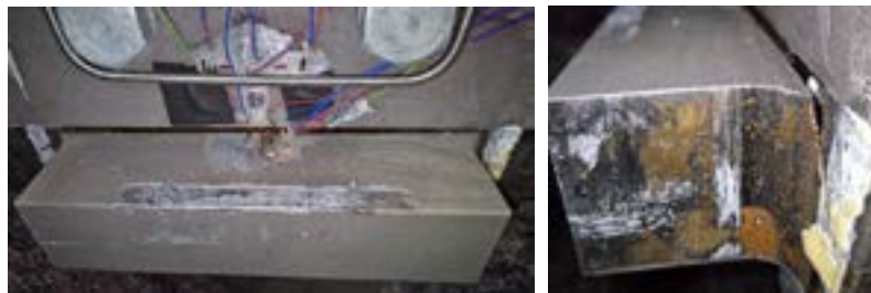
Abbildung 3: li.: Trennriss entlang der Innenkante; re.: Seitenansicht des Trennrisses
