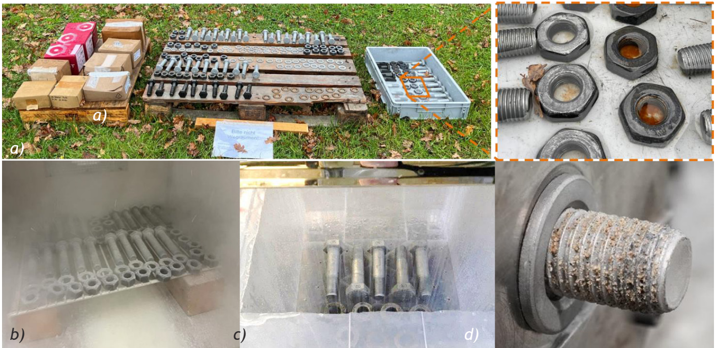
Bild 1: Übersicht einiger im Rahmen des Forschungsvorhabens untersuchten Witterungseinflüsse von Schraubengarnituren a) Auslagerung im Karton, auf einer Palette und in einer Box, b) Lagerung in einer Kühlkammer, c) künstlichen Beregnung und d) Verunreinigung mit grobem Sand
